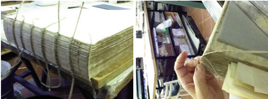
Fig. 4 - Operazione di Cucitura. Legatura a "spaghi passati", realizzata sui nervi di spago (a sinistra) e cucitura a mano del capitello con filo refe (a destra).
